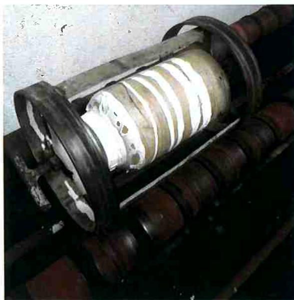
Figura 20. Recipiente contendo suspensão de alumina em rotação sobre o moinho de bolas.
