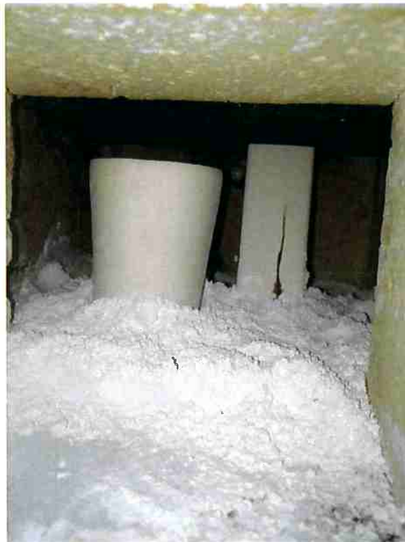
Figura 22. Cadinhos dentro do forno sobre a cama de alumina em pó.
