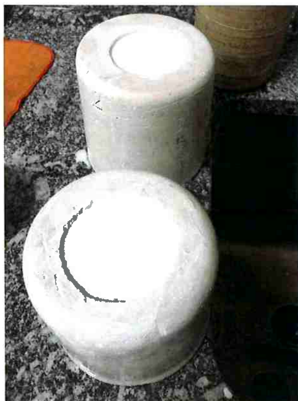
Figura 21. Suspensão de alumina dentro do molde de gesso.
