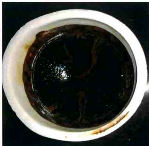
Figura 33. Vidro de basalto formado dentro do cadinho resfriado dentro do forno.
